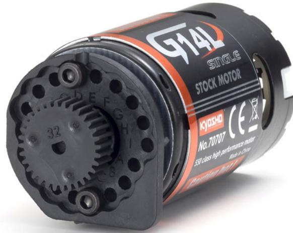
Le réglage standard de l'engrenage droit et du pignon est de 68T et 32T, mais 9 réglages de pignon peuvent être utilisés de 29T à 37T pour produire une large gamme de réglages de rapport de vitesse. Le nouveau support de moteur à engrenage fixe a des trous pour une utilisation avec chaque pignon différent. Montez simplement le moteur directement aux emplacements des trous correspondant au pignon. Aucun réglage du maillage des engrenages n'est nécessaire.
