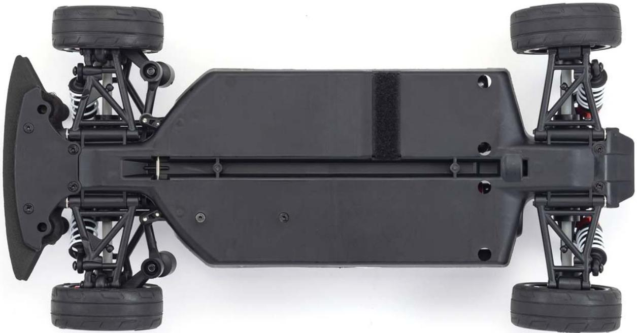
Comporte un nombre réduit et une variété de vis et de pièces, et la consolidation des vis fréquemment utilisées dans la même taille. La plupart des vis sont des vis à tête plate qui peuvent être retirées avec une clé hexagonale de 2,0 mm pour un démontage facile.
