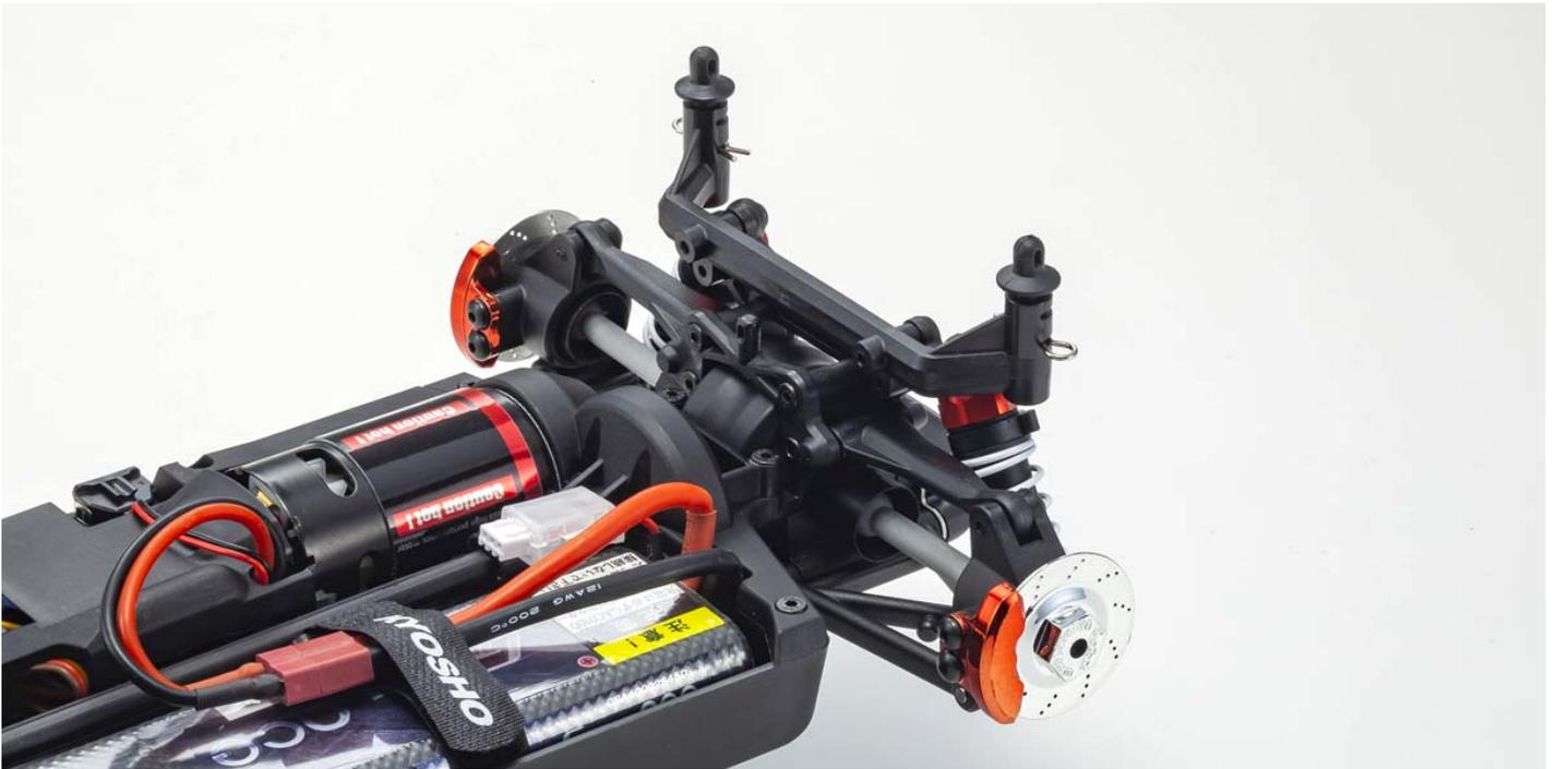
Comprend un choix de deux moyeux de roue à disque de frein décalés avec des étriers factices (pour un style visuel) qui offrent une compatibilité avec les largeurs de carrosserie de 190 mm et 200 mm.
